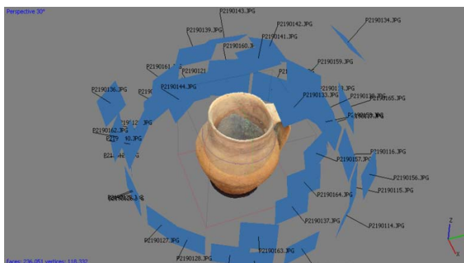
Práctica 1b: Fotogrametría de objeto cercano con Agisoft Photoscan. Alineado de fotos. Jarra medieval. Disponible en http://arqueos.grupos.uniovi.es/bibliotecaarqueologicavirtual3D
